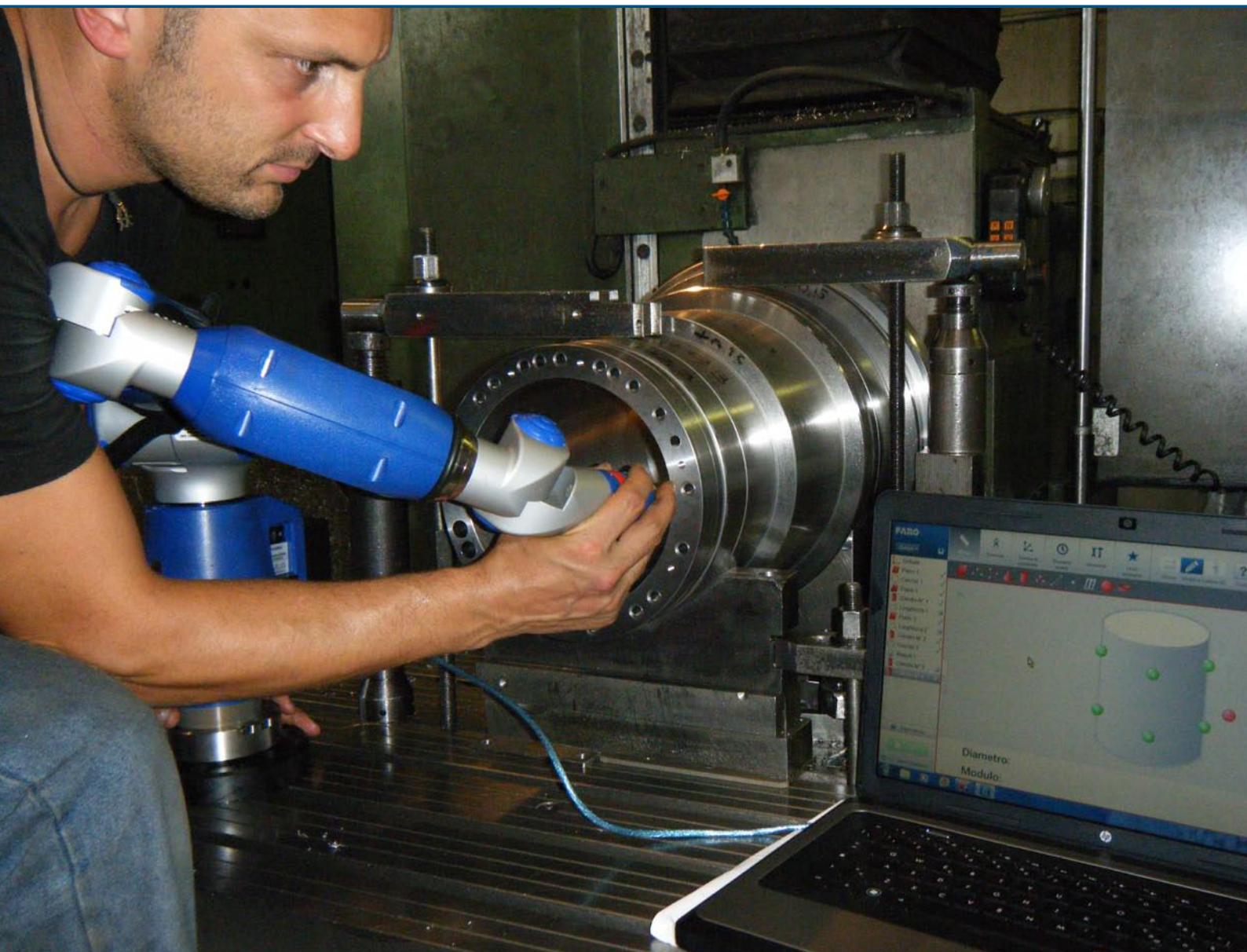
Controllo diametri alesati e interassi spine, eseguito su bussola durante la fase di lavorazione.
