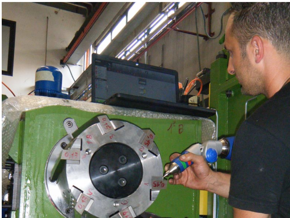
Controllo iterasse tra i tamburi, eseguito su macchina montata.
